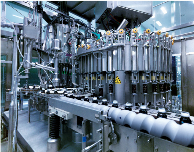
江中谷液体生产线是全球领先的高速全自动无人操作液体制剂生产线，该生产线从取材到预处理、提取、灌装、灭菌直至包装、成箱、入库，实现全程无人自动化操作。主体设备从德国、瑞士、意大利引进，主体车间采用大空间玻璃幕墙分隔。
