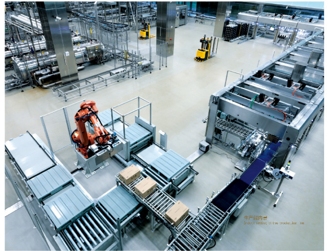
江中谷液体生产线是全球领先的高速全自动无人操作液体制剂生产线，该生产线从取材到预处理、提取、灌装、灭菌直至包装、成箱、入库，实现全程无人自动化操作。主体设备从德国、瑞士、意大利引进，主体车间采用大空间玻璃幕墙分隔。
